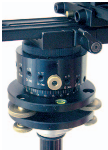
Ohne exakte Ausrichtung erhält man keinen korrekten Horizont. Hier sehen Sie die Nivellierschrauben am Manfrotto-Stativkopf (unten). Oberhalb findet man die Rasterung für konstante Winkel in der Bildreihenfolge.
